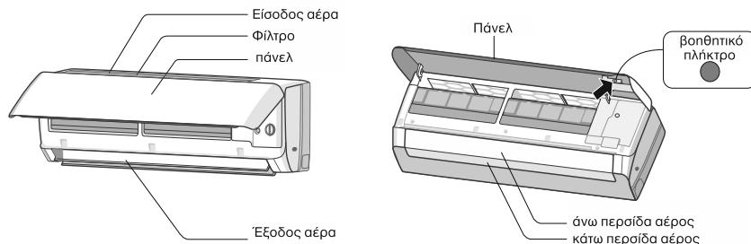
Εάν το τηλεχειριστήριο χαθεί ή καταστραφεί, χρησιμοποιήστε το βοηθητικό πλήκτρο για να ενεργοποιήσετε ή να απενεργοποιήσετε το κλιματιστικό. Η λειτουργία του έχει ως εξής: Όπως φαίνεται στην εικόνα, ανοίξτε το πλαίσιο και πατήστε το βοηθητικό πλήκτρο για να απενεργοποιήσετε το κλιματιστικό. Όταν το κλιματιστικό ενεργοποιηθεί ξανά, θα λειτουργεί σε αυτόματη λειτουργία.
